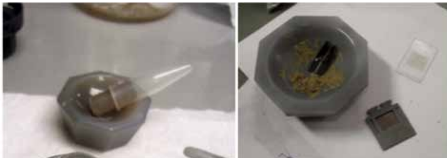
Figura 3.7 Molido de una muestra para análisis por difracción de rayos X.
