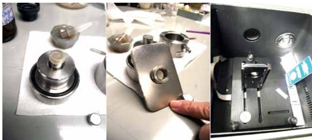
Figura 4.4 Porta muestra con muestra para el análisis en un espectrofotómetro de haz.
