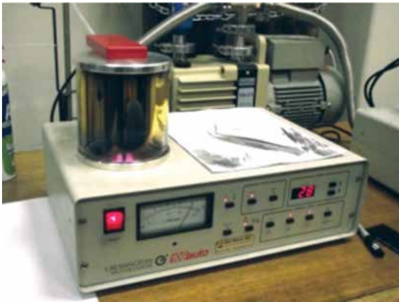
Figura 9.5 Cámara para el recubrimiento de muestras no conductoras..
