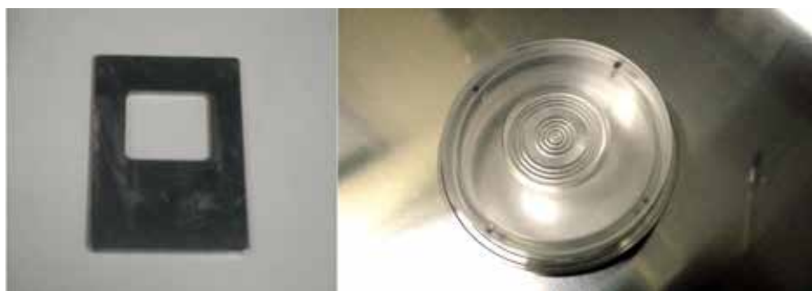
Figura 3.8 Portamuestras metálico y de lucita para análisis por difracción de rayos X.
