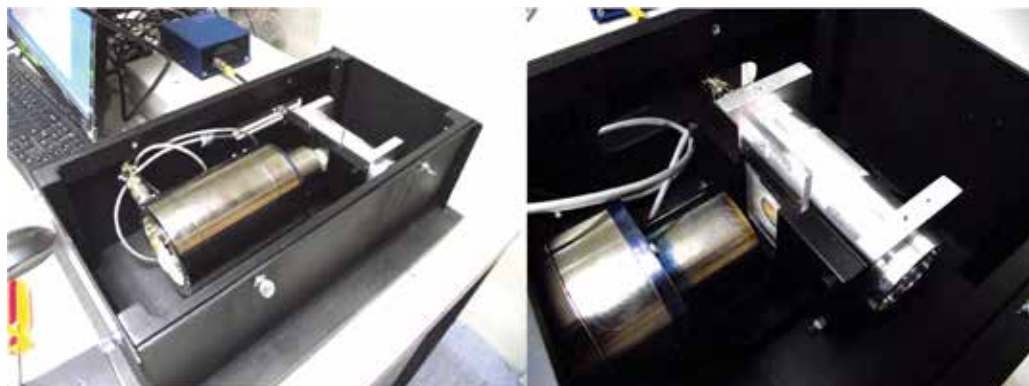
Figura 5.3 Fuente donde se encuentra el ^{57}\text{Co} con la cual opera un equipo Mössbauer.
