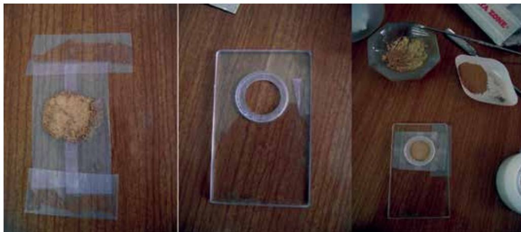
Figura 5.7 Preparación de la muestra para analizar por medio de espectroscopía Mössbauer.
