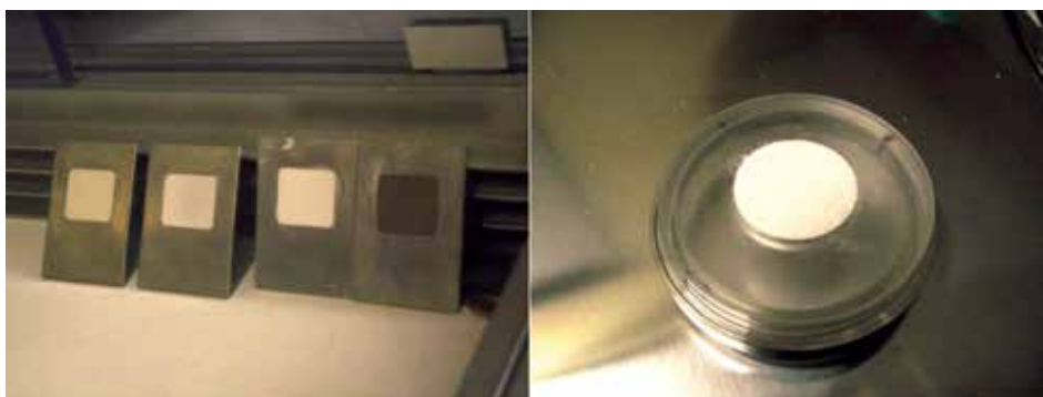
Figura 3.9 Portamuestras con muestras previo a un análisis por difracción de rayos X.
